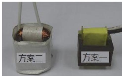
图 7 两种方案实验用电流互感器
